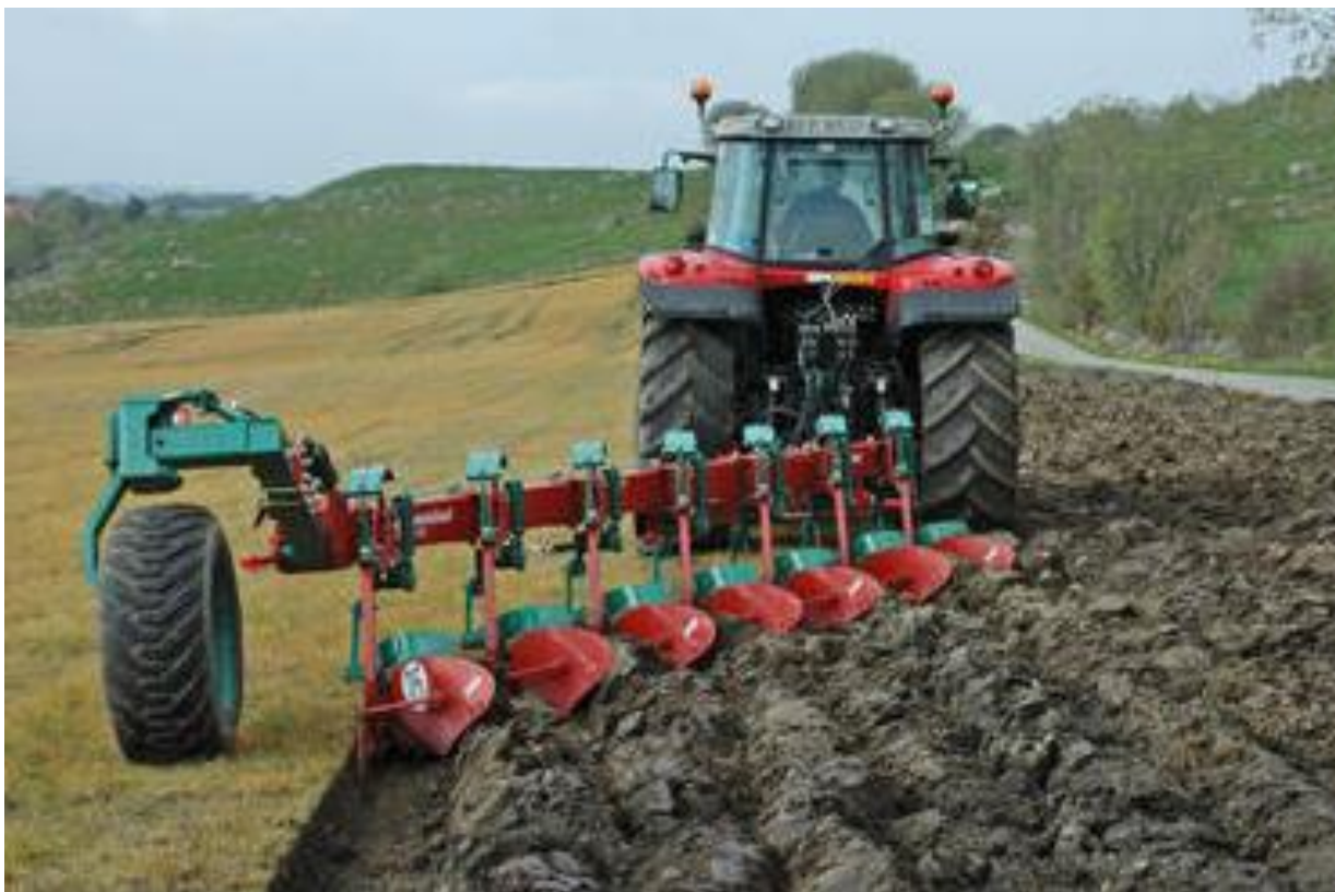
Pług użyźnia ziemię, czyli kruszy i odwraca, żeby przygotować ją pod uprawę.
